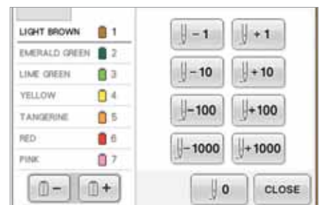
Verbesserte Funktionen für genaueres Arbeiten Um die Nadel an eine bestimmte Position im Stickmuster zu setzen (z.B. nach einem Fadenriss) können Sie bis zu +/- 1000 Stiche im Muster springen. Mit Hilfe der Kamera können Sie die Position im Display sehen.
