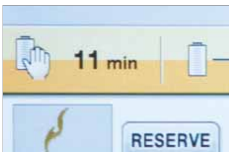
Anzeige für Garnwechsel Das Display zeigt Ihnen die verbleibende Zeit bis zum nächsten Garnwechsel an.
