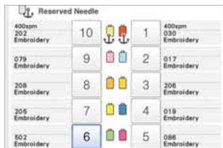
Variable Geschwindigkeit von 400 bis 1000 Stichen pro Minute Wählen Sie die individuelle Nähgeschwindigkeit für Ihr Projekt aus. Es können einzelne Nadeln verschiedenen Geschwindigkeiten zugewiesen werden.
